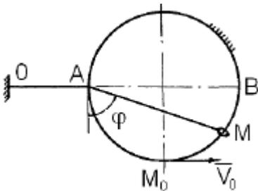
5. На тело массой  $m$ , скользящее по горизонтальной прямой, действует сила притяжения к центру  $O$ , расположенному на этой прямой. Сила притяжения пропорциональна расстоянию тела от центра  $O$ , коэффициент пропорциональности –  $k^2 m$ . Считая, что движение тела началось из пункта  $M_0$ , удаленного от центра  $O$  на расстояние  $\ell$  без начальной скорости, определить, пренебрегая трением, скорость тела в момент прохождения им центра  $O$ .
